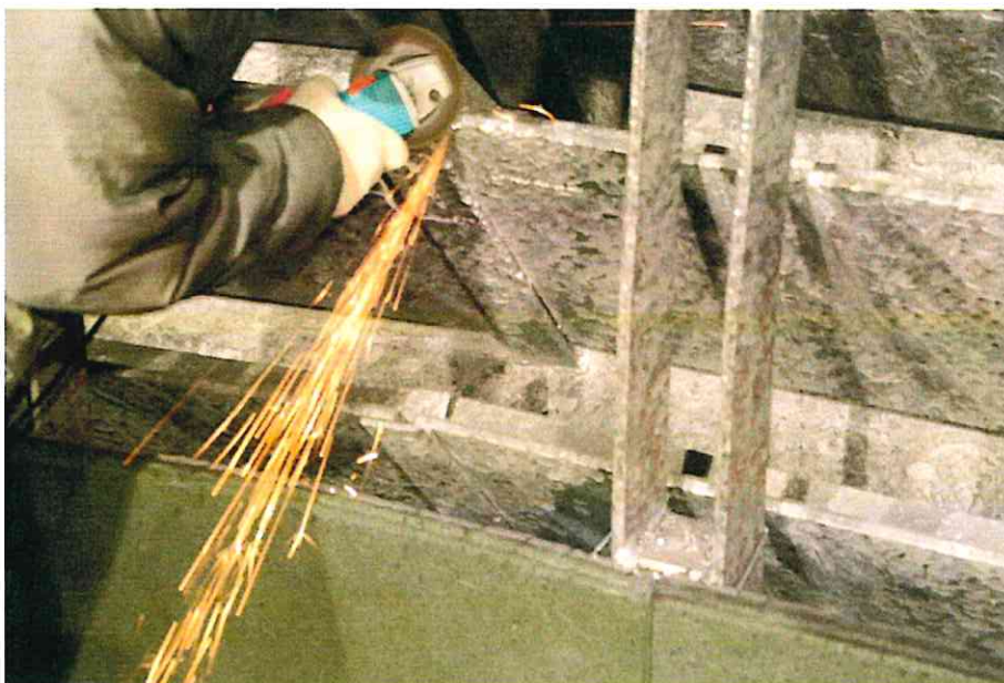
Fot.20 Próba iskrowa na krawędzi płyty, gdzie tarcza została wprowadzona w materiał płyty na głębokość 5 mm
