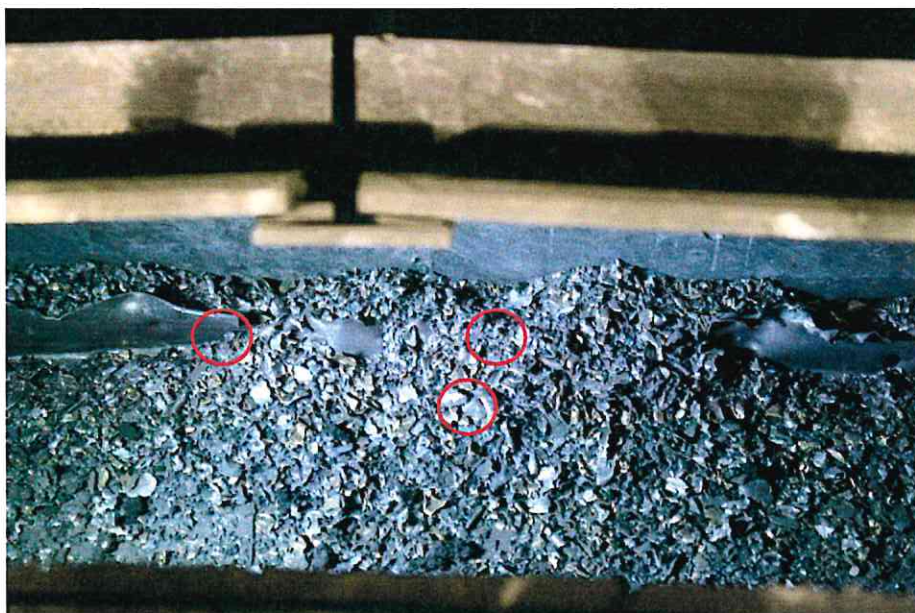
Fot.16. Widok złomu, powstałego w wyniku fragmentacji pocisków, uderzających w płyty łapacza pocisków. Widoczne są fragmenty pocisków z rdzeniem stalowym
