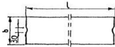
c) wpusty na powierzchniach stykowych krawężników
