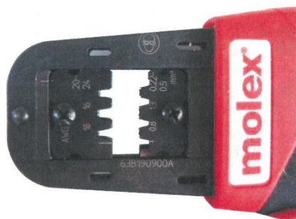
Rysunek 39 - Tabela ustawień zaciskarki MOLEX.
