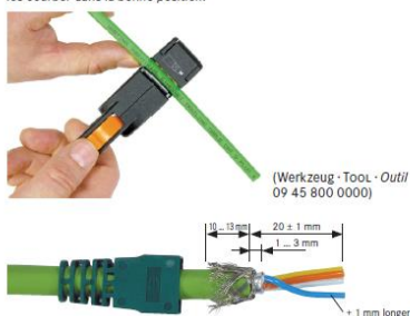
Rysunek 43 Instrukcja montażu złącza RJ45 na kablu PROFINET.
