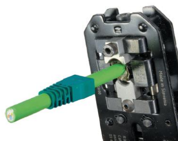
Rysunek 43 Instrukcja montażu złącza RJ45 na kablu PROFINET.
